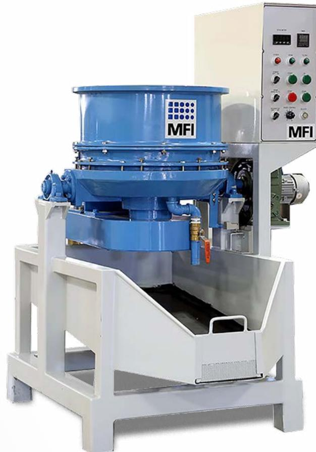
**Las acabadoras de discos centrífugos** son máquinas de alta velocidad. Sus características de carga y descarga superiores abiertas hacen que sea fácil automatizarlas en una producción en línea. Una fuerza g de 6-8 se produce en los medios y las piezas por el disco que gira en el fondo del recipiente y los mueve contra las paredes laterales estacionarias. Esto crea un poderoso vórtice en el fondo de la cámara de acabado que ayuda a lograr resultados de acabado rápidos.
